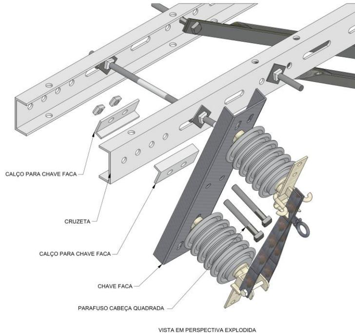
**Figura 2** - Detalhe de aplicação de calço peça F86
